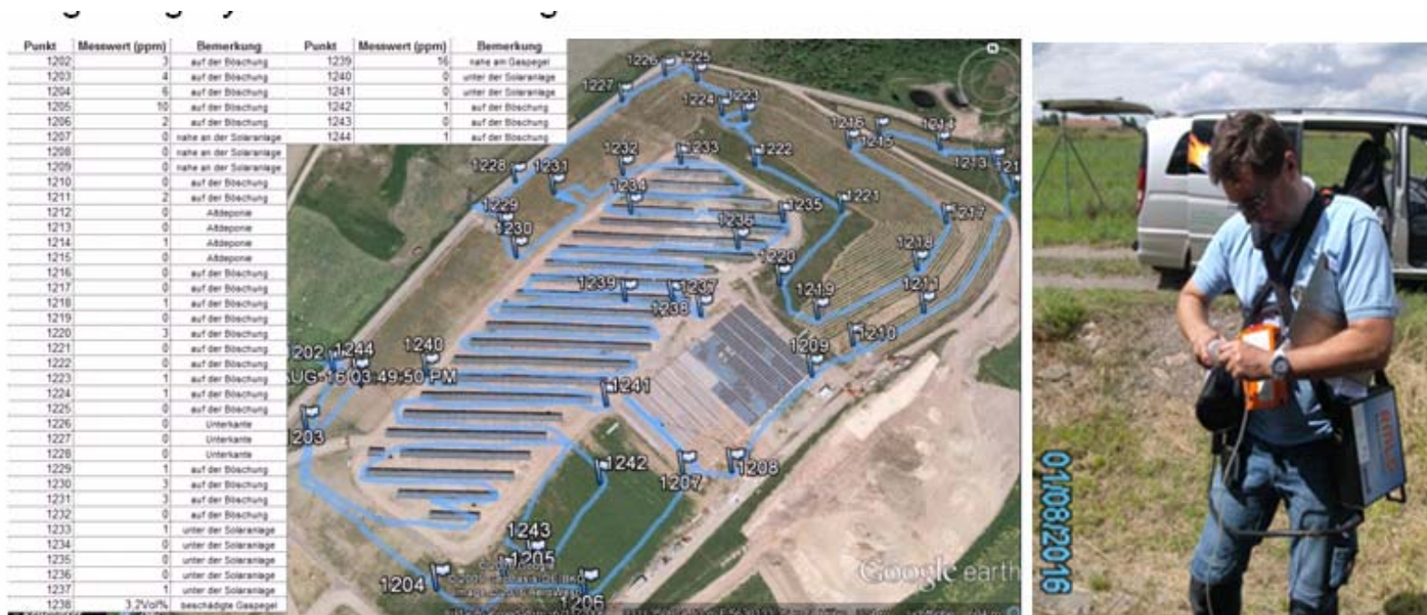
Abb. 17 GPS – Wegpunkte (Meßergebnisse mittels RMLD - Laser und HS 680) und GPS – Begehungsweg
